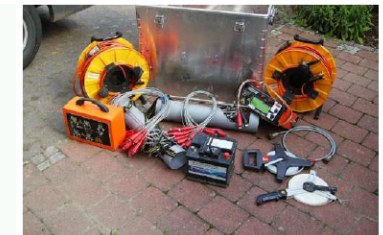
Abbildung 6 und 7: Schema geoelektrischer Widerstandssondierung nach Wenner; Messapparatur.
